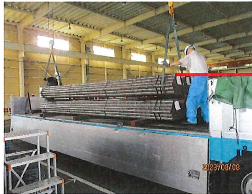
床面から鋼材上部までの高さ 2.05m
